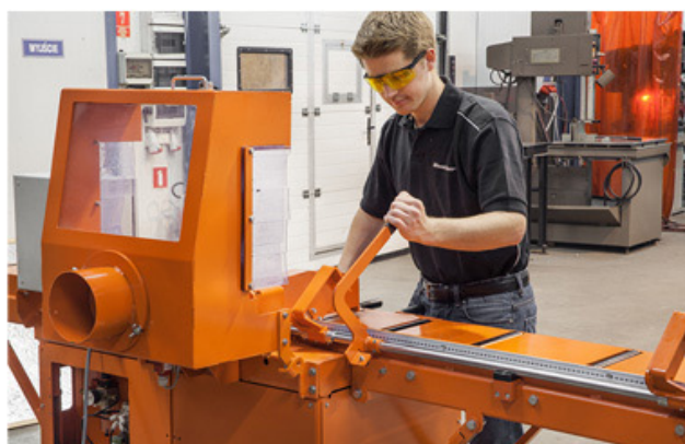
La XC100 se fabrica en Europa y cuenta con la certificación CE. Las tablas quedan fijadas y la sierra circular se eleva para el corte.
