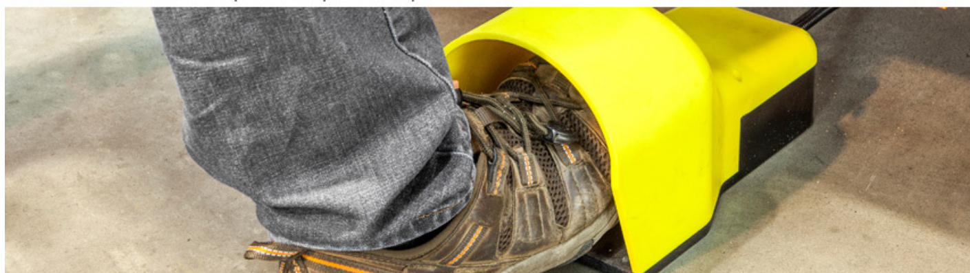
El pedal acciona el corte, permitiendo al operario mantenerse a una distancia de seguridad durante el corte.
