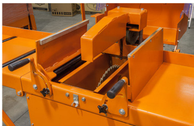
La XC100 se fabrica en Europa y cuenta con la certificación CE. Las tablas quedan fijadas y la sierra circular se eleva para el corte.
