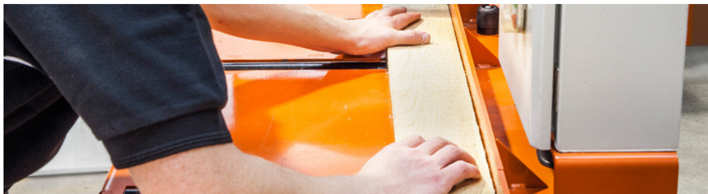
La XC100 es una sierra tronczadora compacta diseñada para integrarse fácilmente en líneas de aserrado. La capacidad de tablas es de 60 mm de alto por 200 mm de ancho.
